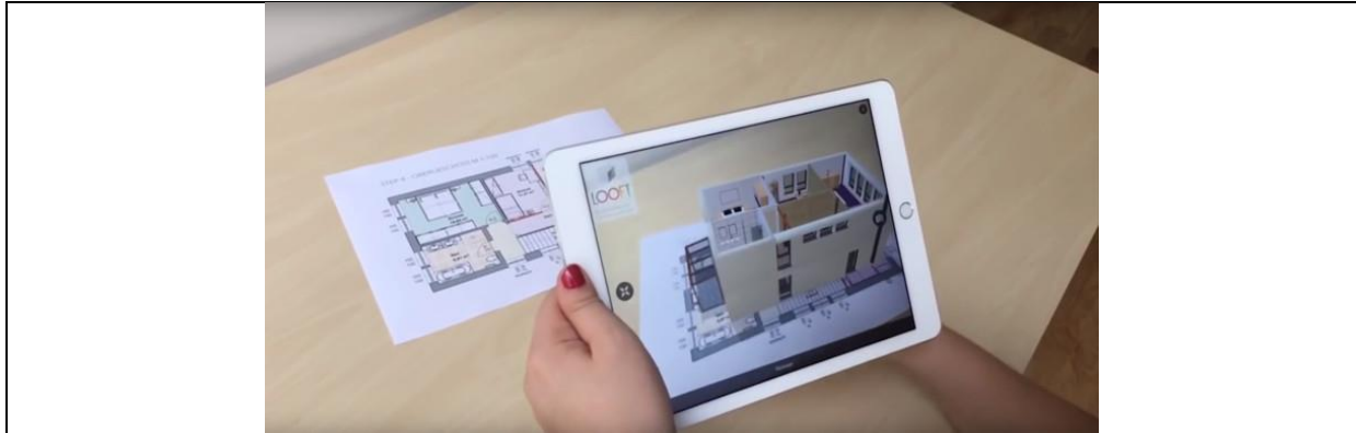
شکل 14: استفاده از واقعیت افزوده مبتنی بر نشانگر به منظور نمایش و درک بهتر از سازه طراحی شده
