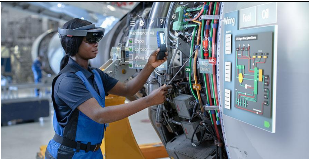
شکل 13: استفاده از واقعیت افزوده برای عیب‌یابی و تشخیص راحت‌تر تعمیرات وسایل مکانیکی و الکتریکی
