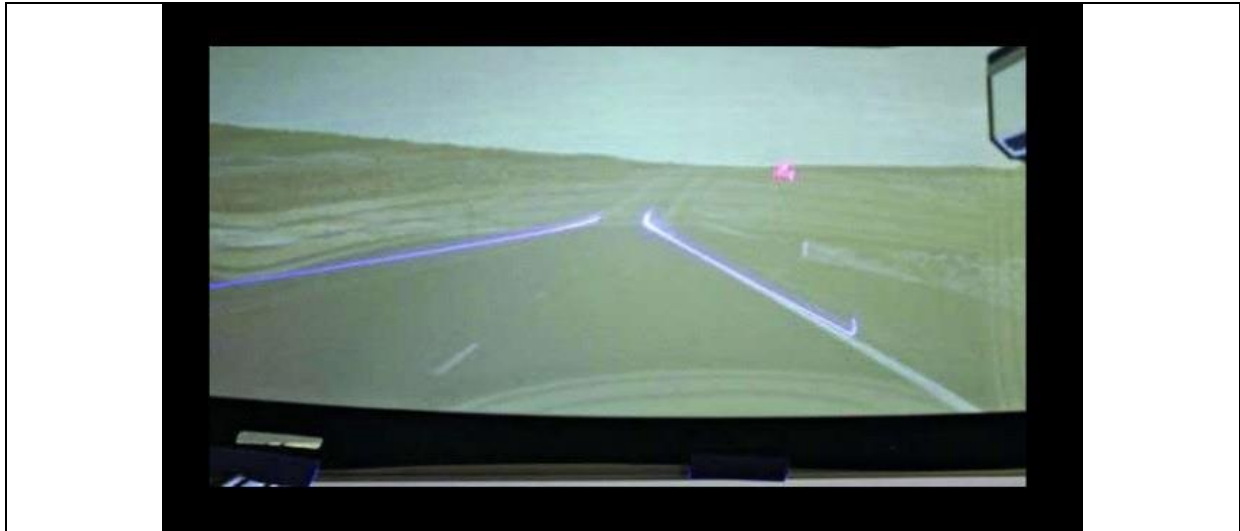
شکل 10: تشخیص و نمایش مرز جاده در محیط جاده تاریک با استفاده از واقعیت افزوده تشریحی (منبع: digit.in)
